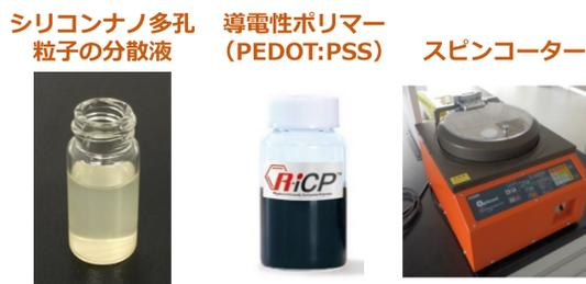
図7 太陽電池の作製に使用した材料と装置
