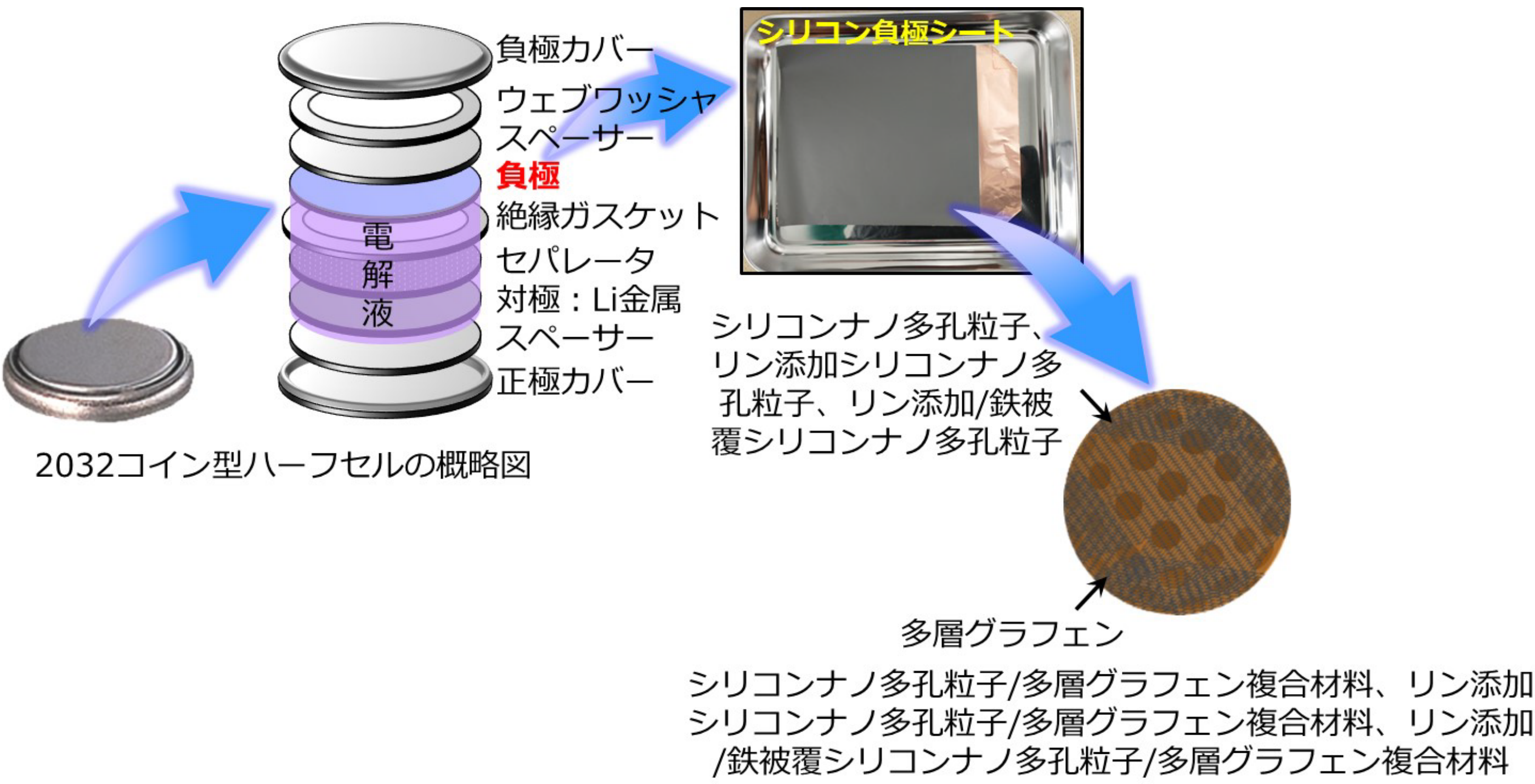
図5 シリコンナノ多孔粒子/多層グラフェン負極、リン添加シリコンナノ多孔粒子/多層グラフェン負極、リン添加/鉄被覆シリコンナノ多孔粒子/多層グラフェン負極を用いたハーフセルの構造図と導電助剤有無の各種シリコンナノ多孔粒子/多層グラフェン負極を用いたハーフセルのサイクル数に対する充電容量保持率の変化
