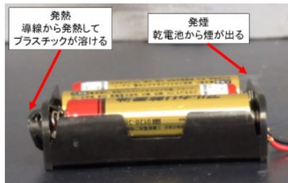
図6 電池ボックス使用時の注意点（乾電池3本を10秒間接続したときの状態）
