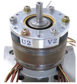
30,000 r/min で浮上回転するベアリングレスモータ
