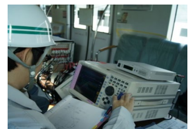
試運転試験による電気鉄道車両の電力測定(車両内の測定風景)
