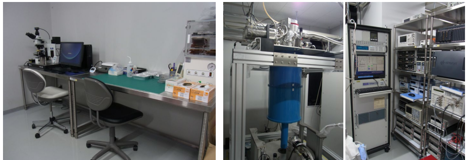
原子層転写装置（左）極低温冷凍機システム（中央）計測装置群（右）の写真
