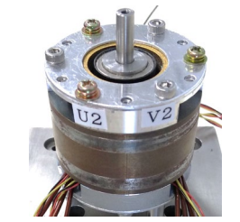
30,000 r/min で浮上回転する高速ベアリングレスモータ
