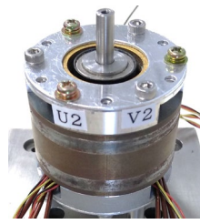
30,000 r/min で浮上回転する高速ベアリングレスモータ
