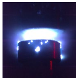
真空遮断器内のアーク
