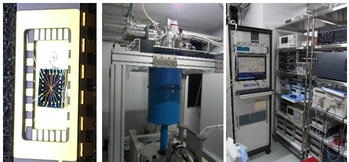
（左）研究室で作製した原子層電子デバイスチップ （中央）極低温冷凍機システム（右）計測装置群
