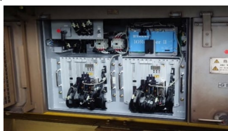
渡邊研との共同研究：車両に設置した鉄道車両のインバータ遠隔監視装置
