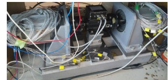
3.7kW IPMモータ試験装置
